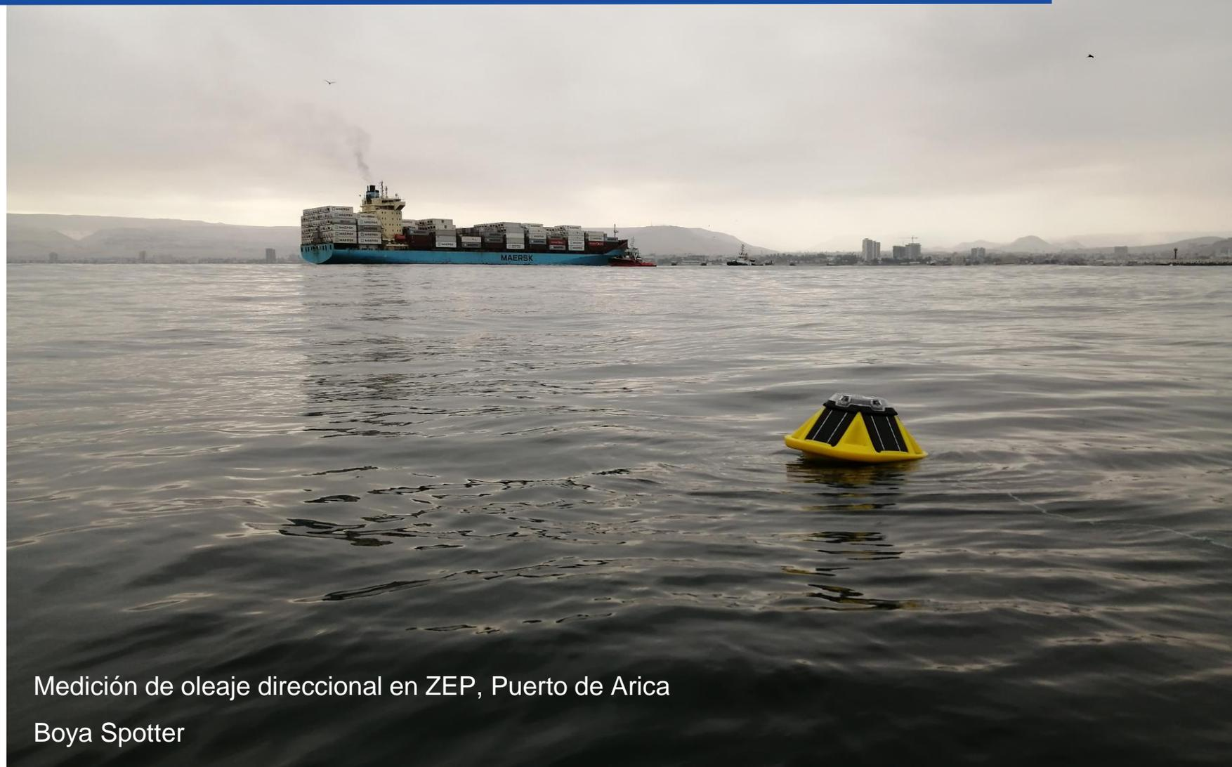
Medición de oleaje direccional en ZEP, Puerto de Arica
