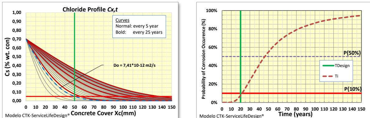
Figura 6: Diseño por Vida Útil para un hormigón sumergido según Modelo CTK-ServiceLifeDesign®.
