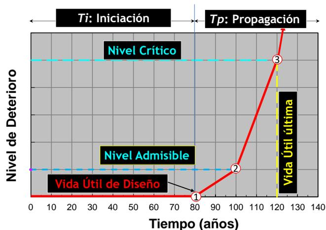
Figura 3: Modelo de Vida Útil de Tuutti.
