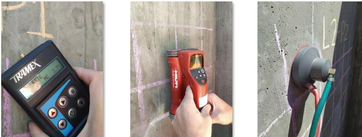
Figura 8: Aplicación de ensayos no-destructivos para Control de Vida Útil con Modelo CTK-ConcreLife®.
