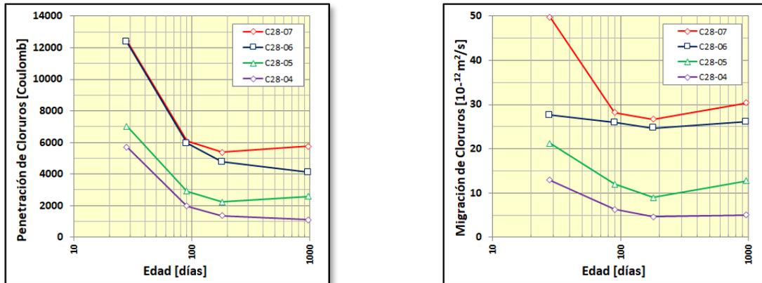
Figura 5: Disminución de valores de  $Q$  y  $M$  (aumento de Resistencia al Ingreso de Cloruros) con el tiempo.
