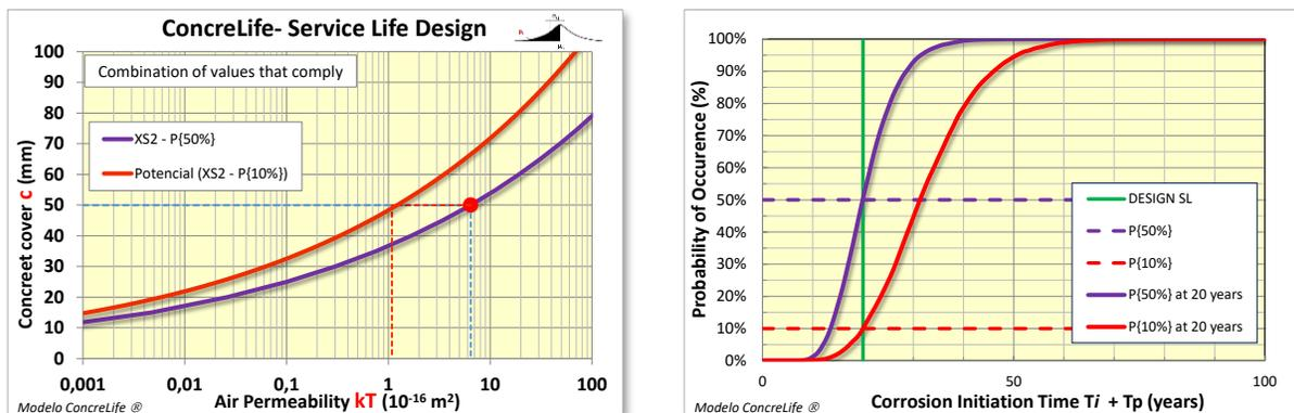
Figura 7: Diseño por Vida Útil para un hormigón sumergido según Modelo CTK-ConcreLife®.
